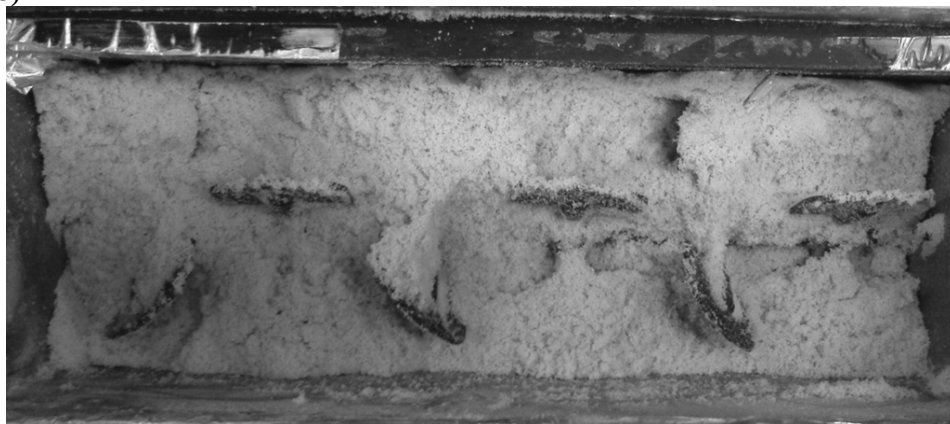
Fot. 2. Wnętrze mieszarki podczas natłuszczania: a) przy zbyt intensywnym lub za dużym dodatku tłuszczu, b) przy prawidłowym przebiegu procesu natłuszczania
