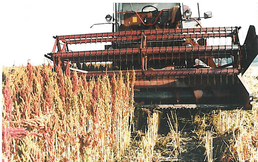
Fot. 6. Jednoetapowy zbiór amarantusa częścią hederu Photo 6. Amaranth plants harvest with part of header
