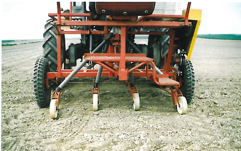
Fot. 1. Wysiew nasion amarantusa siewnikiem SPZ - 1,5 Photo 1. Amaranth seed sowing with SPZ - 1,5
