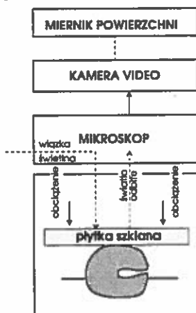
Rys. 2.2. Schemat układu pomiarowego rzeczywistego powierzchni kontaktu
