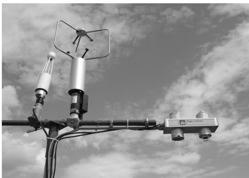
Rys. 1. Przyrządy pomiarowe (od lewej): analizator gazowy CO 2 /H 2 O, anemometr soniczny, bilansomierz Fig. 1. Measuring instruments (from left) : gas analyzer CO 2 /H 2 O, sonic anemometer, radiometer
