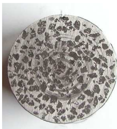
Fot. 2. Przekrój poprzeczny próby agregatów glebowych ze stopem Wood'a
