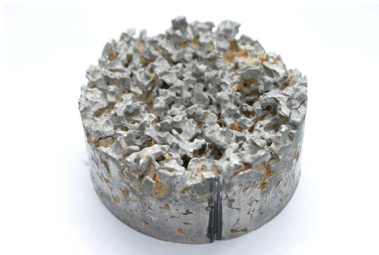
Fot. 1. Makropory międzyagregatowe na górnej powierzchni próby wypełnionej stopem Wood'a Photo. 1. Interaggregate macropores on the upper surface of aggregate bed filled with Wood's alloy
