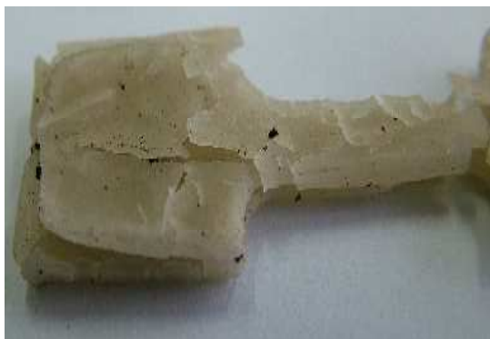
Fot. 5. Wypraski po 4 tygodniach przechowywania w glebie
