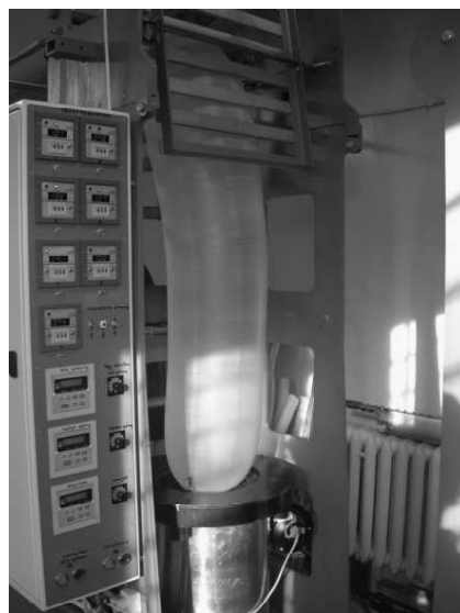
Fot. 3. Wyłaczanie folii biodegradowalnej Photo 3. Extrusion of biodegradable film
