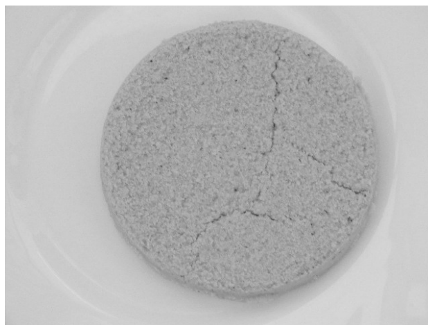
Fot. 1. Faza stała uzyskana laboratoryjnie (rozdziel na lejku Büchnera) Photo 1. Solid phase obtained in laboratory (separation on Büchner funnel)
